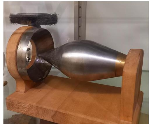
Durch eine solche Düsen-nadel wird der Wasserdruck in Fließgeschwindigkeit umgewandelt und erreicht so bei einer Fallhöhe von 500 m eine Geschwindigkeit von nahezu 400 km/h.
